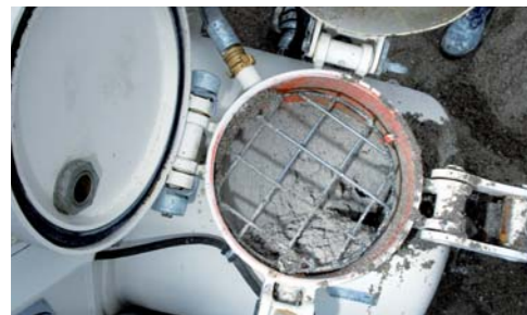
3 Dann wird die gewünschte plastische Verarbeitungskonsistenz eingestellt...
