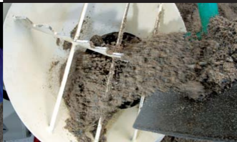
2 Anschließend werden Bindemittel, Anmachwasser und die restliche Gesteinskörnung zugegeben.
